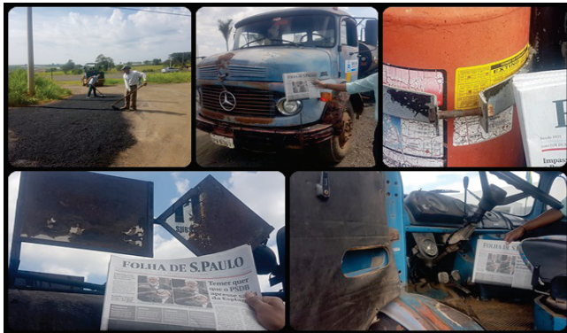
Asfalto: Atentem-se para as condições do caminhão e da Kombi destinada ao transporte dos servidores, extintores de incêndio vencidos, placas de perigo enferrujadas, falta de sinalização (cones) na estrada para proteção dos servidores.
